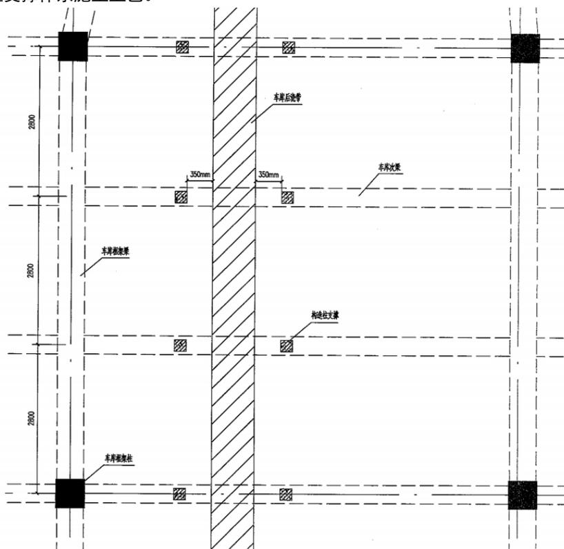
本工程地下车库柱网间距 8.4m×8.4m，结构层高为 3.6m，次梁间距 2.8m，经过承载力及稳定性验算，决定在后浇带垂直相交的顶板主次梁端部(距离后浇带边 350mm)均设置一根 200mm×200mm 的素混凝土构造柱独立支撑。
