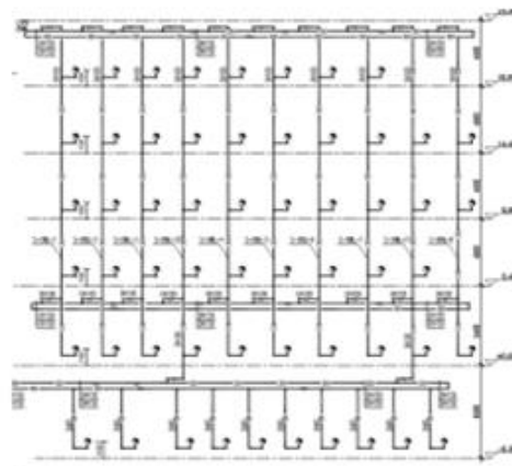
图 6 北楼室内消火栓系统图
