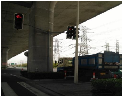
图 18 路灯杆成为无障碍通道上的障碍
