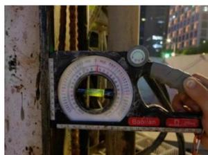
图 8 角度尺(斜向加固)
