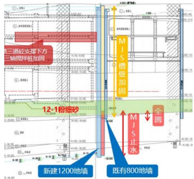
图 5 某车站地保区 MJS 加固剖面图
