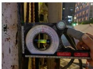
图 8 角度尺(斜向加固)
