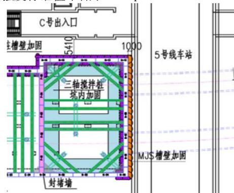
图 4 某车站地保区 MJS 加固平面图
