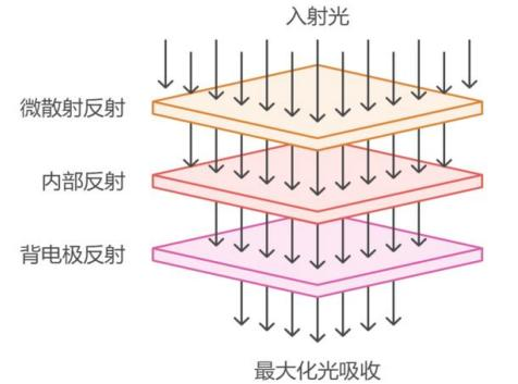
图 2 光伏电池中多层反射结构实现的光吸收示意图
