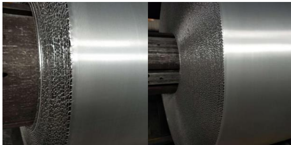
a. 铸轧区长度 65mm b. 铸轧区长度 55mm 图2 不同铸轧区边部裂边情况照片对比
