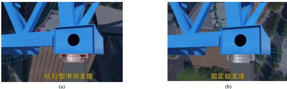
图 4 圆环钢结构与塔楼之间的支座形式示意图
