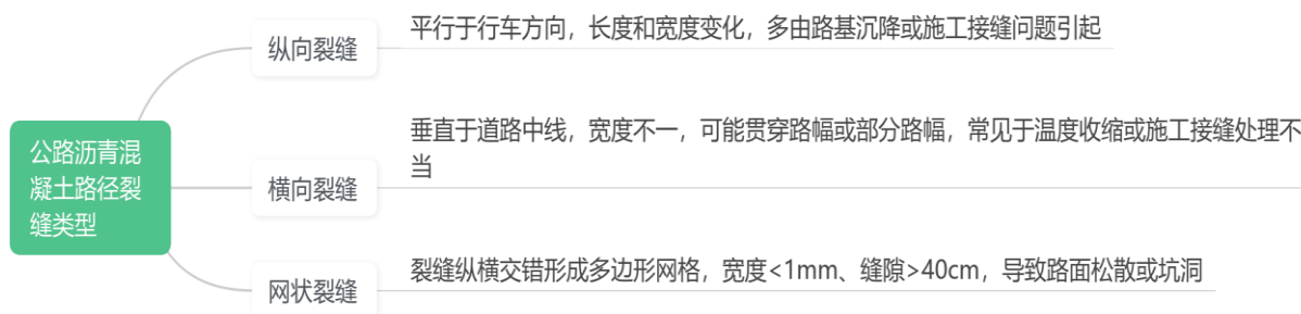
图1 公路沥青混凝土路面裂缝类型
