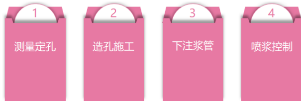
图1 水利堤防工程施工流程
