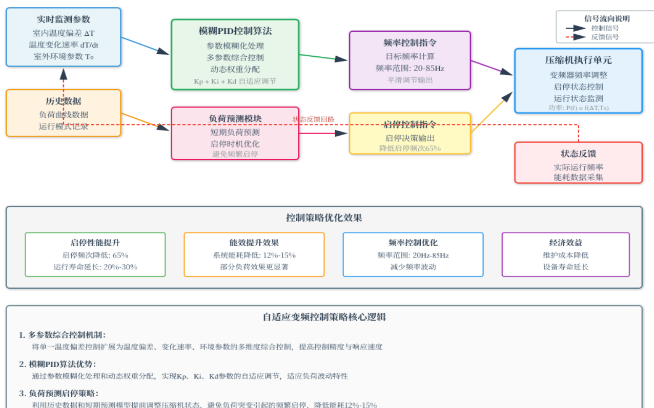
图1 压缩机自适应变频控制策略优化机制
