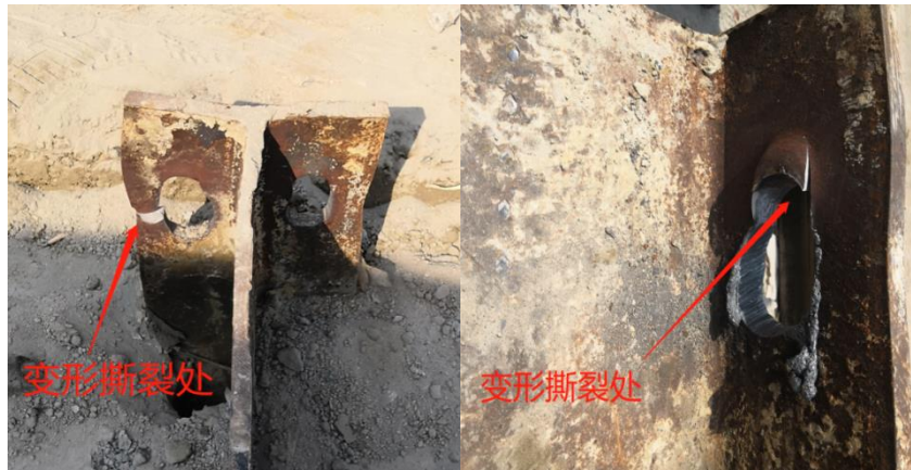
图2 H型钢翼边(起拔插销孔)变形撕裂
