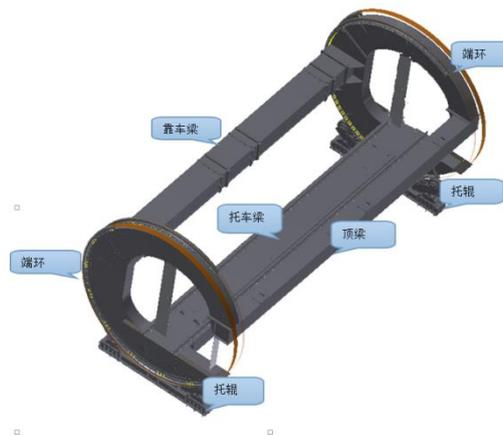
图 1 转子拼装示意图
