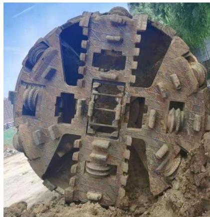
图 3 顶管机刀盘配置图
