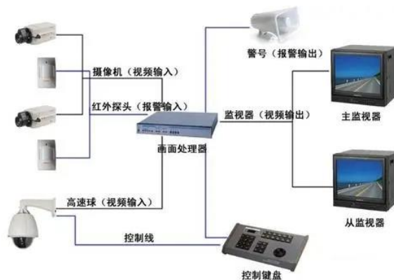
图1 交通设施监控设施系统
