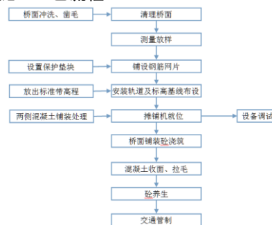
图 5.1 桥面铺装施工工艺流程图
