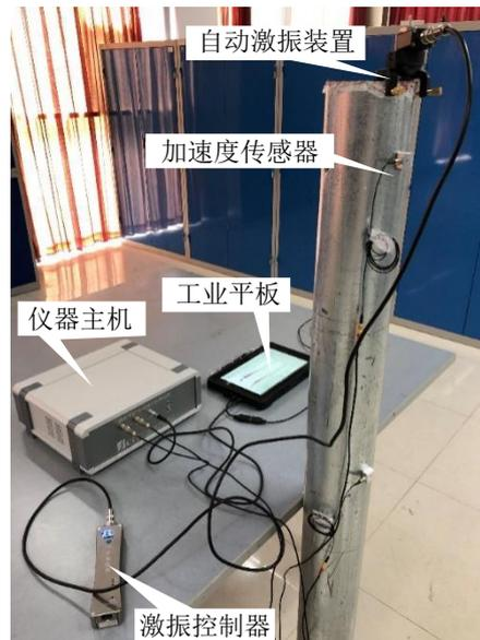
图 11 钢质护栏立柱埋深检测仪接线布置
