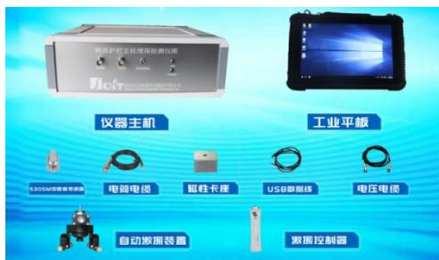
图 10 钢质护栏立柱埋深检测仪
