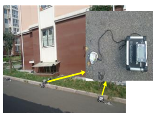
图1 建筑物周边爆破振动监测点布置
