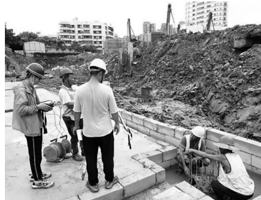
图1 超声波法现场检测
