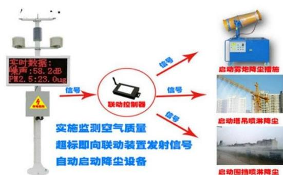
图2 环境监测自动喷淋联动示意图
