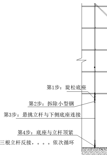
图9 立杆转换步骤图
