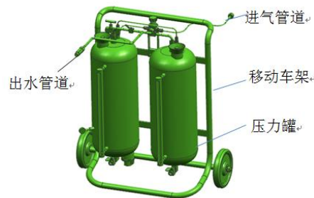
图2 清洗装置三维结构图
