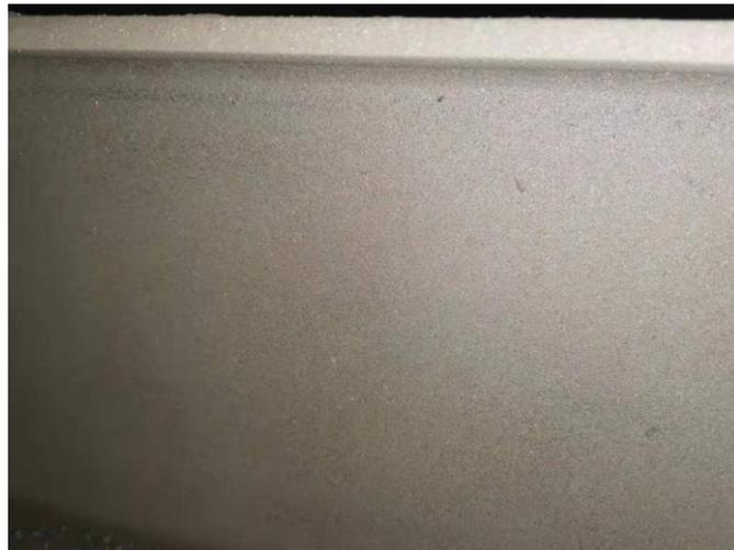
图 1 钢材基体表面喷砂 Sa2.5 级效果图
