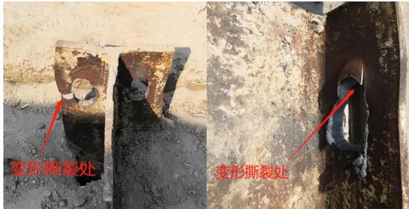
图2 H型钢翼边(起拔插销孔)变形撕裂
