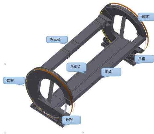
图1 转子拼装示意图
