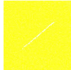
图 2 l = 6\text{mm} , \alpha = 40^\circ 时的试样模型
