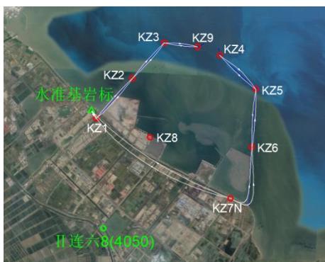
图 3 水准控制网路线图
