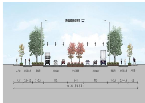
图 9 四幅道路典型断面
