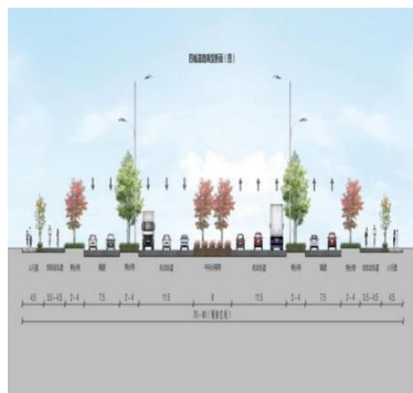
图 8 四幅道路典型断面
