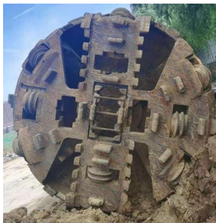
图 3 顶管机刀盘配置图
