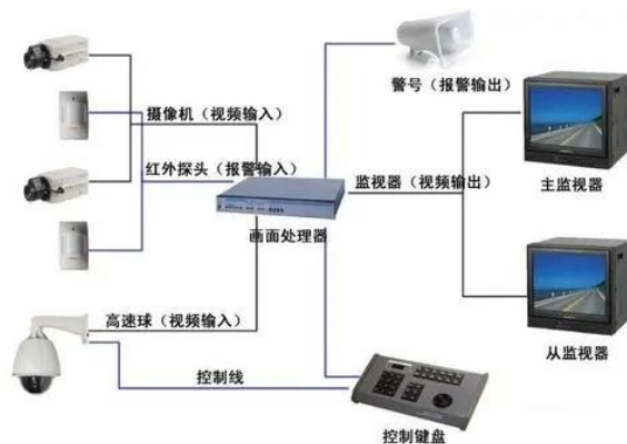
图1 交通设施监控设施系统
