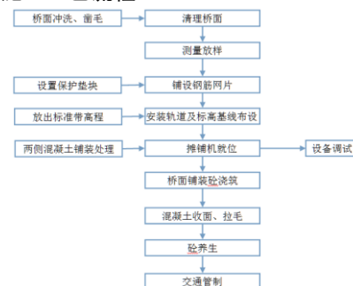
图 5.1 桥面铺装施工工艺流程图
