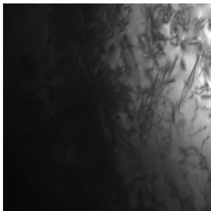
图2 热-机械循环后 Fe-Mn-Si 系记忆合金位错图
