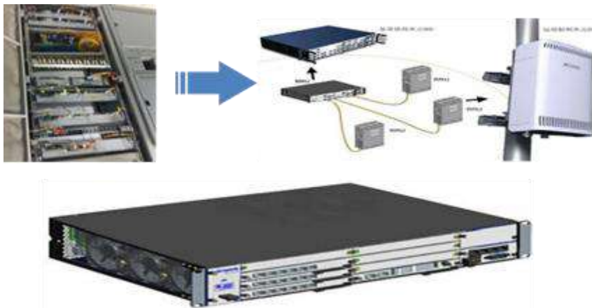
图 2 BBU 集中式部署安装及至 RRU 连接方式示意图
