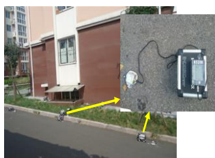
图1 建筑物周边爆破振动监测点布置
