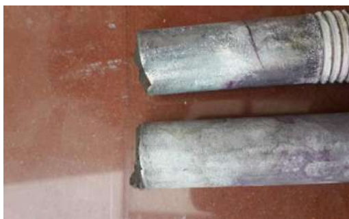
断螺栓其他部位发现环装裂纹
