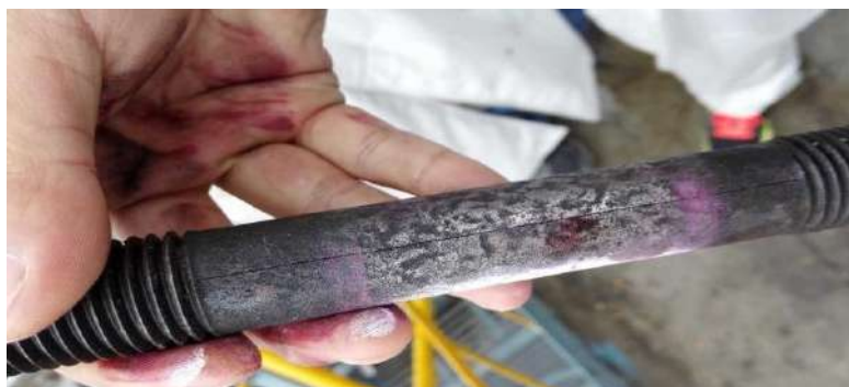
未断螺栓呈现纵向裂纹
