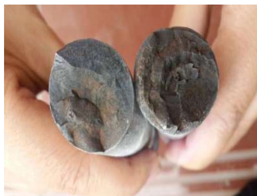
螺栓断裂断面
