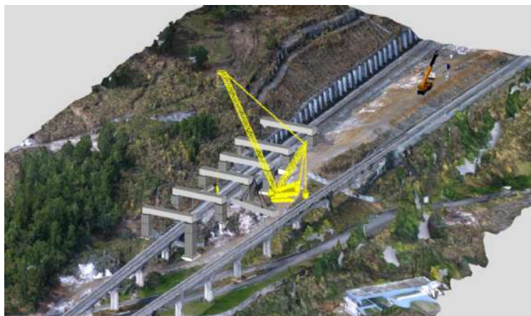
图 5 三维实景地形与三维构件模型融合
