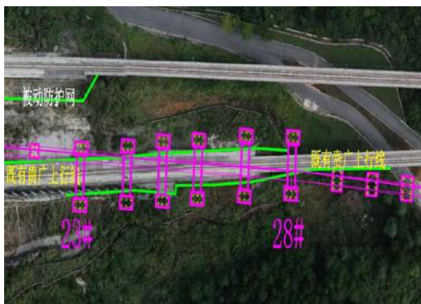
图 1 门式墩上跨既有高铁平面位置关系图
