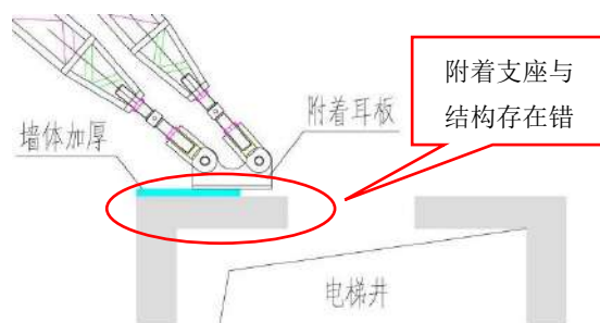
图 3 附着支座与结构存在错台
