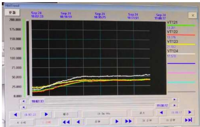
图3 检修后试车振动趋势
