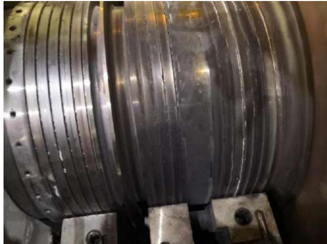
图2 汽轮机后汽封轴向磨损情况
