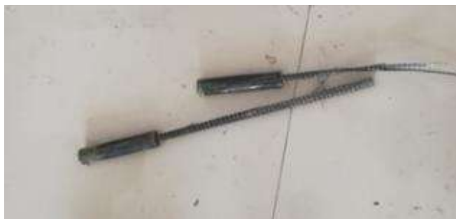
图 3.1.1 断裂的 GFRP 筋
