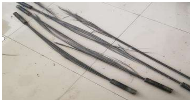
图 3.1.3 断裂的 GFRP 筋
