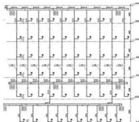
图 6 北楼室内消火栓系统图
