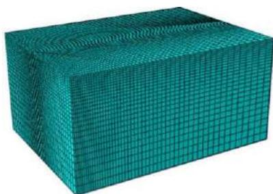
图2 沙土地面三维模型及网格
