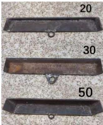
图 4 不同高度履刺形状
