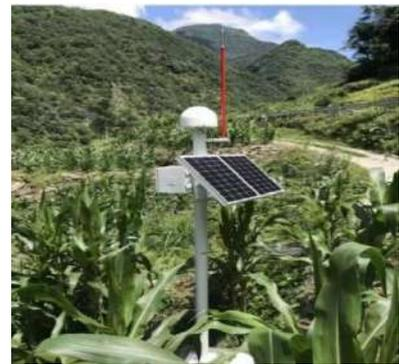
图 2 GNSS 基准站
