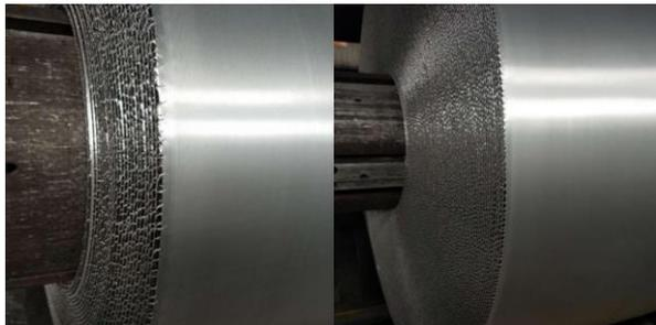
a. 铸轧区长度 65mm      b. 铸轧区长度 55mm
