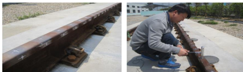
图 7 获取钢轨振动衰减率的实验
