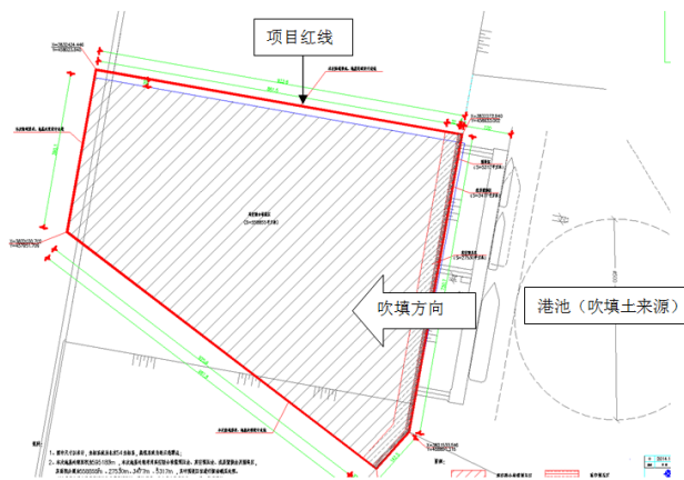
图1 徐圩港区一期工程地基处理平面图
