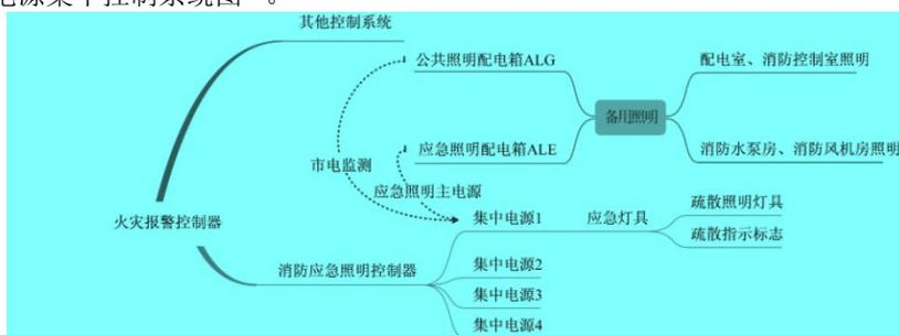
图1 集中电源集中控制型应急照明系统构成拓扑图
