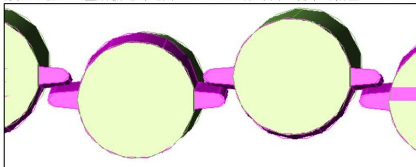
图 5 相邻两根桩斜率偏差发生肋板碰撞示意图
