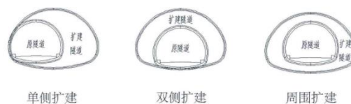
图3 隧道扩挖方式图
