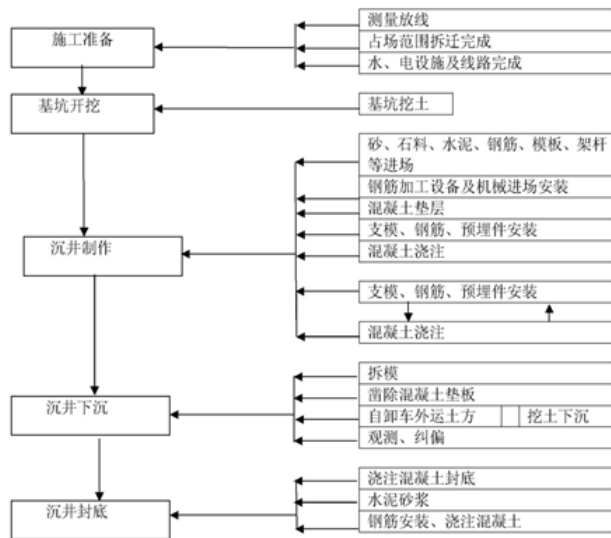
图 2 沉井施工工艺流程
