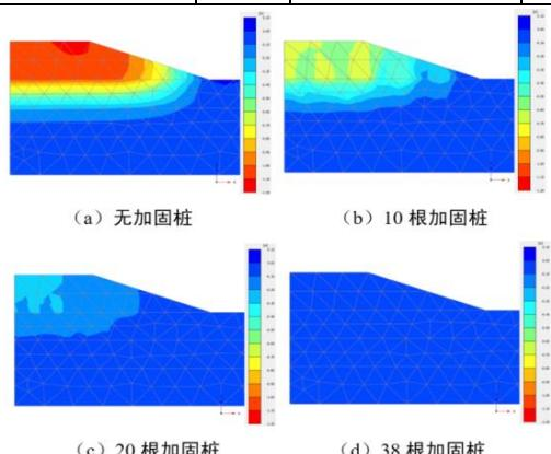
图 6 不同加固桩数量条件下路基沉降变形云图
