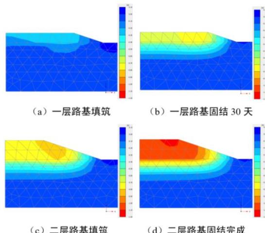
图 5 无加固方案路基沉降变形云图
