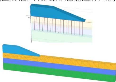
图 2 路基填筑计算整体模型
