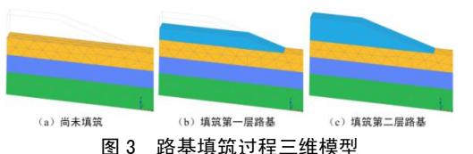
图 3 路基填筑过程三维模型
