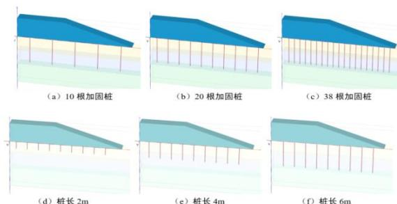
图 4 不同工况加固桩的计算模型
