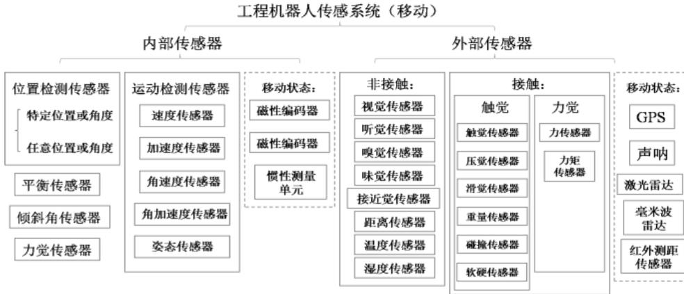
图2 工程机器人传感器系统（移动）
