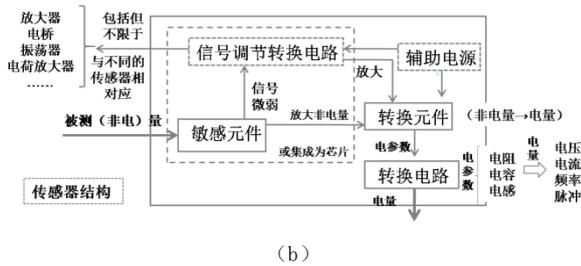
图1 (a) 工程机器人主要结构框图; (b) 传感器主要结构框图
