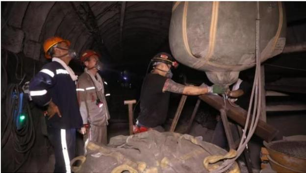
图2 吨包溜货槽
