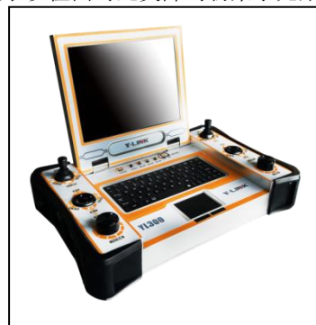
图4 管道机器人的主控器
