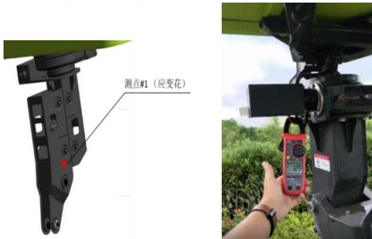
图7 轻量化剪叉臂实车安装图 图8 回转电流监测测试
