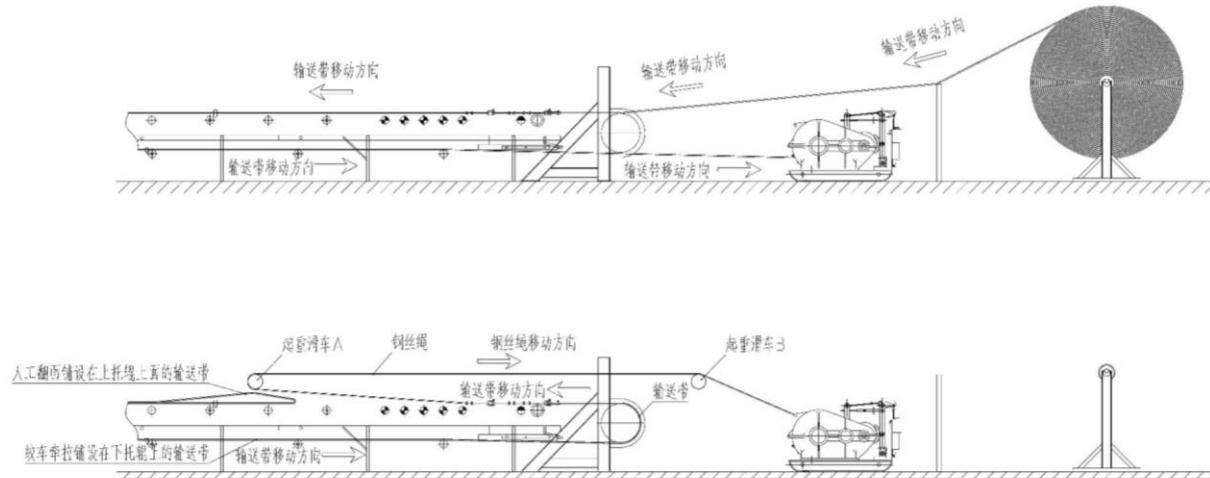
图 1 输送带铺装原理示意图
