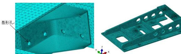
图 11 优化结构有限元模型图
