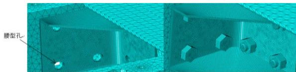
图 3 腰型孔及螺栓局部模型图
