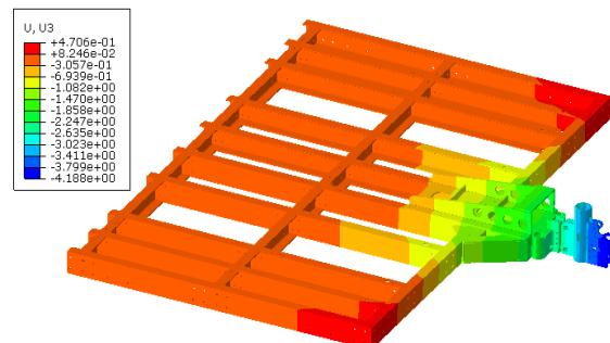
图 12 工况一装载平台牵引锁位移云图(去除蒙皮显示)
