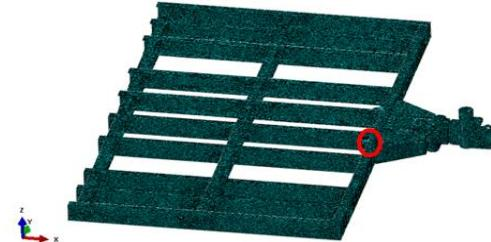
图 2 装载平台主承力结构（去蒙皮显示）有限元模型
