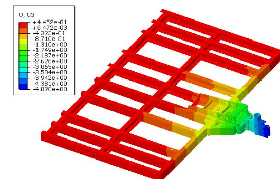
图 13 工况二装载平台牵引锁位移云图(去除蒙皮显示)
