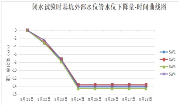
图8 坑外水位监测管水位下降量变化曲线图
