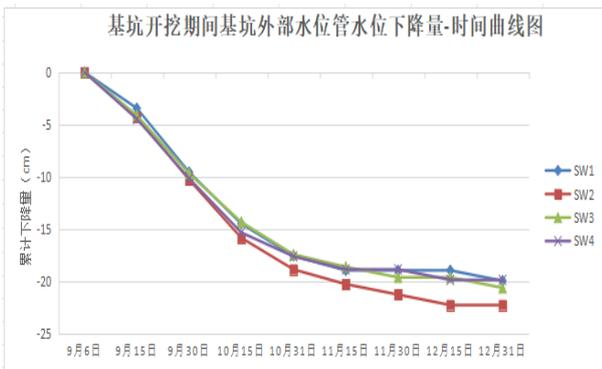
图9 坑外水位监测管水位下降量变化曲线图
