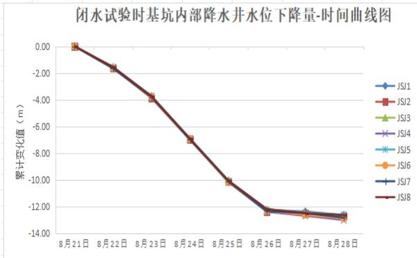
图7 坑内降水井水位下降量变化曲线图
