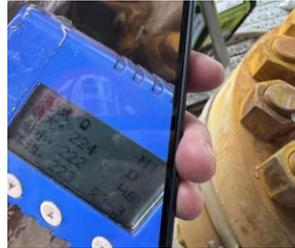
图 4 焊缝硬度检查
