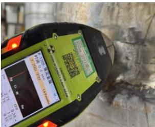
图 3 焊缝光谱检查
